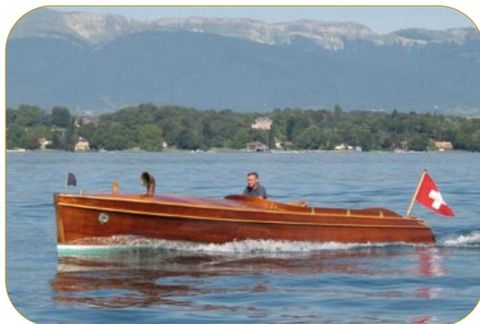
Le bateau a été construit en 1913. Sa restauration, entreprise en 2019 par le chantier naval de Corsier-Port, a nécessité plus de 3500 heures de travail. Autre aspect remarquable : **IDA** est l'un des rares canots au monde à être désormais équipé d'un moteur identique à celui monté à l'époque, soit un Type Félix 4 cylindres, conçu en 1912. A relever également : la qualité du dossier de candidature.
